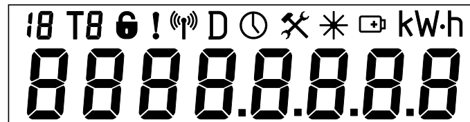
Рисунок 7.1 – Общий вид ЖКИ счетчика в режиме теста
